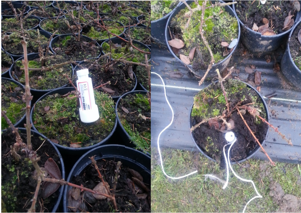
Figur 2. Bilden visar placeringen av t.v. logger i skottzonen och t.h. loggern nergrävd i rotzonen, dvs i krukans.
